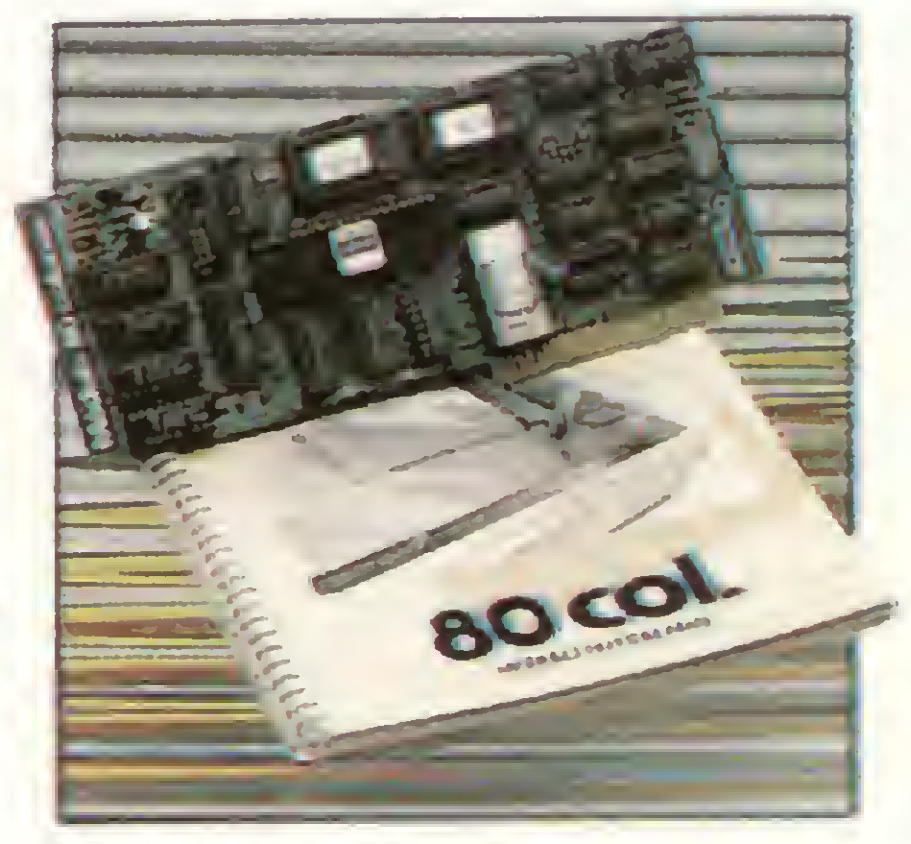
80 colunas: Módulo para mudança do padrão de vídeo para 80 colunas x 24 linhas.
